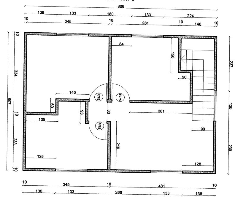
Planta de Arquitectura Segundo Nivel Superf.: 48,00 m2 escala 1:50
